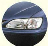
マルチリフレクターヘッドランプ ●写真はG Package, スパシオ。
