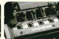
LASRE α-II 7A EFI 16VALVE 総排気量:1,762cc 最高出力 (NET) 88kW (120PS)/6,000r.p.m. 最大トルク (NET) 157N・m (16.0kg・m)/4,400r.p.m.
