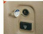
DC12V電源/AC100V電源 ●100W以下の電圧製品をお使いください。 ただし、100W以下の電圧製品でも正常に作動しない場合があります。詳しくは取扱書をご確認ください。
