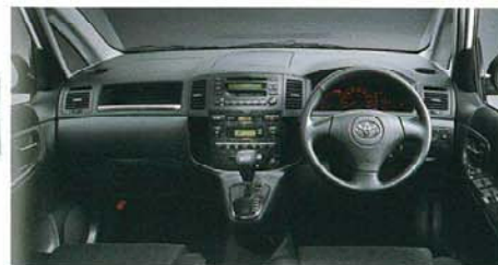
Photo: 1. BS AEROTOURERの計器盤と室内。内装色はダークグレー。CD-カセット一体AM/FMマルチ電子チューナー付ラジオはメーカーオプション。 ●計器盤の写真は機能説明のために各ランプを点灯させたものです。実際の走行状態を示すものではありません。
