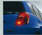
リヤフォグランプ ●リヤフォグランプを設置した場合は、 テールランプの点灯は必ず変わります。
