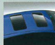
ツインツームーンルーフ (フロント:チルト、リヤ:スライド)
