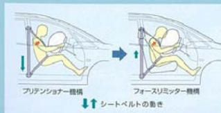
プリテンショナー&フォースリミッター機構付シートベルト
