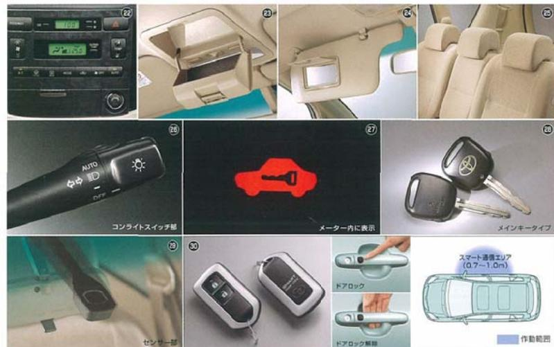
●この先進のシステムは、従来のワイヤレスドアロックリモートコントロール機能に加え、車両に搭載された発信機から電波を受信し、車両とスマートキーとの間で電子IDコードを照合する機能を実現します。
